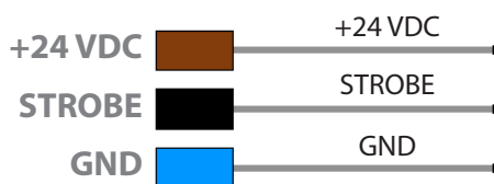
Podłączenie oświetlacza w trybie strobe Minimalny prąd wyzwolenia strobe - 0,01 A Maksymalna częstotliwość strobe - 1000 Hz
